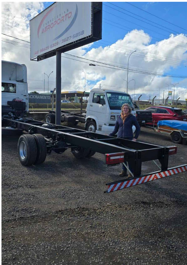
Foto: Carrocerias Aeroporto - Mudança de entre-eixo e alongamento de balanço traseiro (Precisão de fábrica, impacto na estrada)
