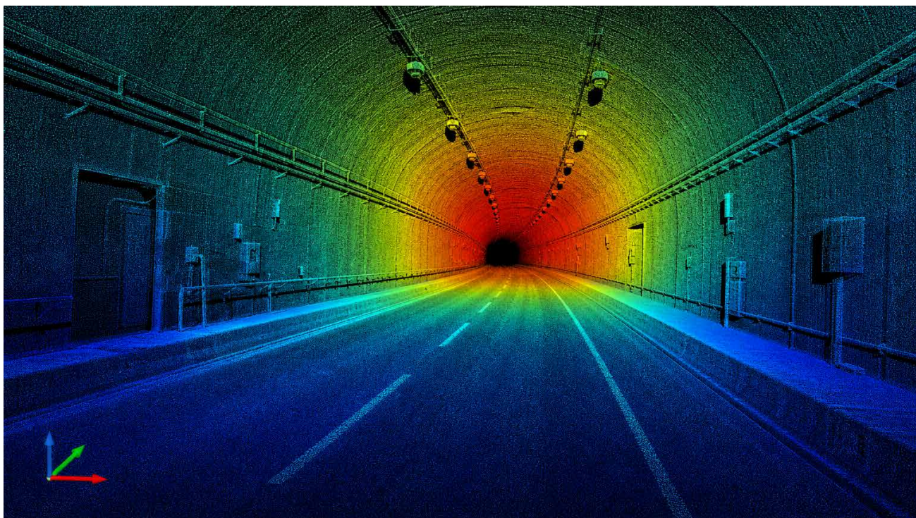
Figura 4 – Laser SLAM aplicado no levantamento subterrâneo de túneis Fonte: Gerada pelo o autor utilizando IA.
